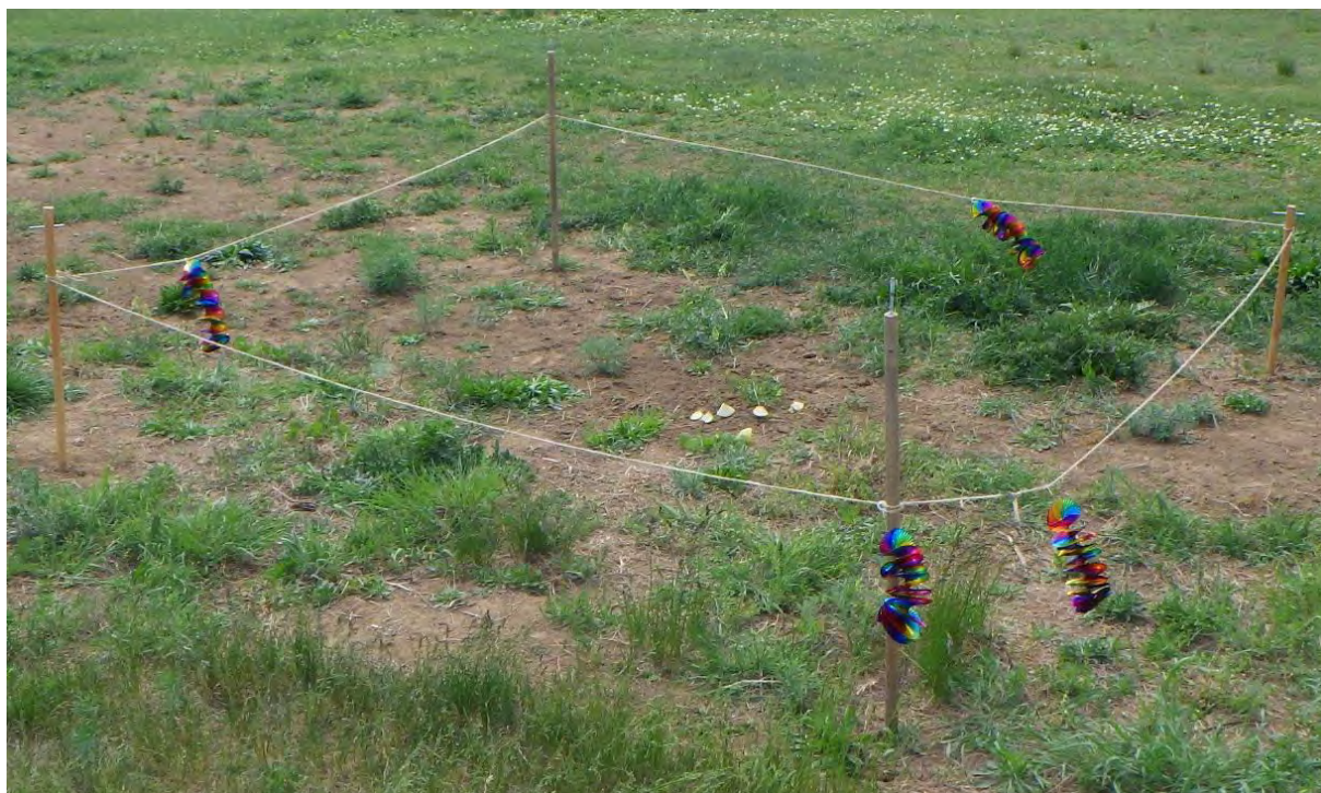
Obr. P5.38 Nefunkční testované opatření: zrakový plašič ve formě barevných spirál na experimentální ploše v Miroslavi. Sysli na plašič nereagovali.
